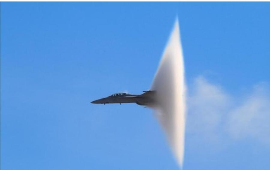
*Figura 5: Un F/A-18 vola a velocità transoniche (Mach 0,8-1,2). La nuvola di condensa di vapore acqueo è generata dagli effetti dell'aumento della pressione nel cono di Mach (foto dal web)*
