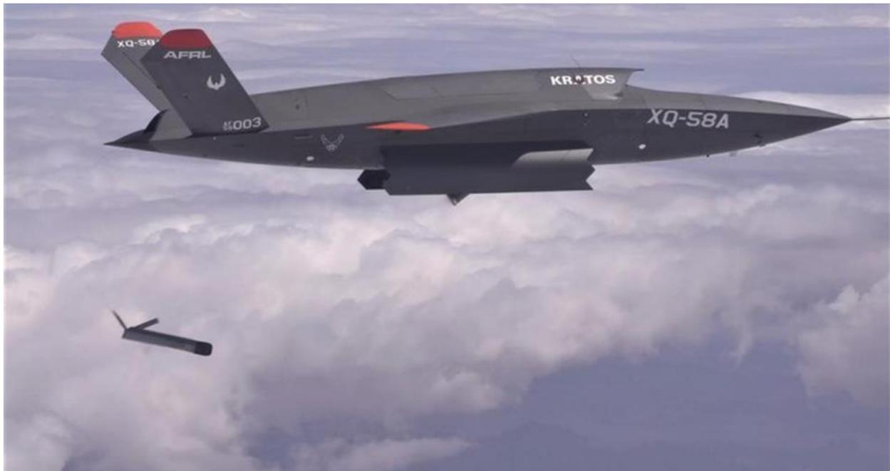
*Figura 3: Il drone Kratos XQ-58A Valkyrie lancia per la prima volta dalla sua stiva interna un piccolo velivolo senza pilota (credit: Aviation-Report.com)*
