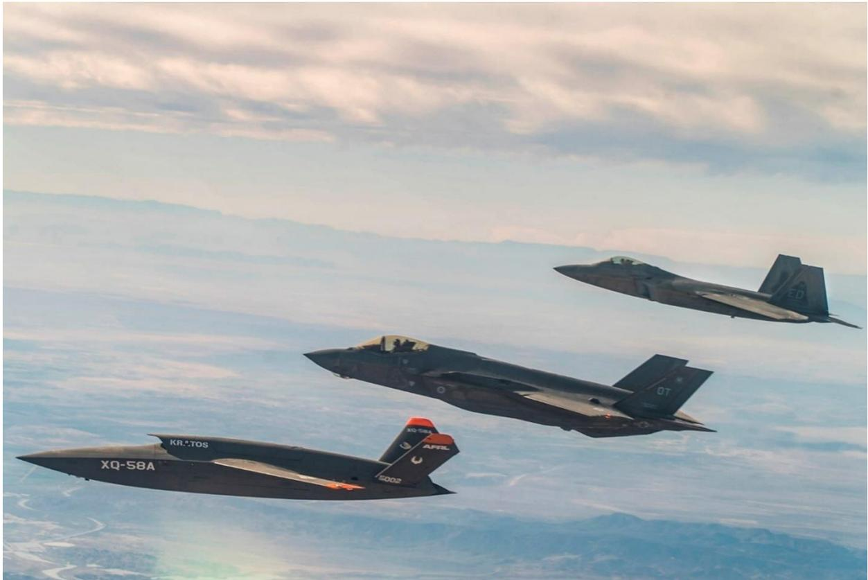
*Figura 1: Il volo dell'XQ-58A Valkyrie come loyal wingman pilotato dall'AI assieme a velivoli pilotati da umani, nell'ambito del programma Skyborg (credit: airandspaceforces.com)*
