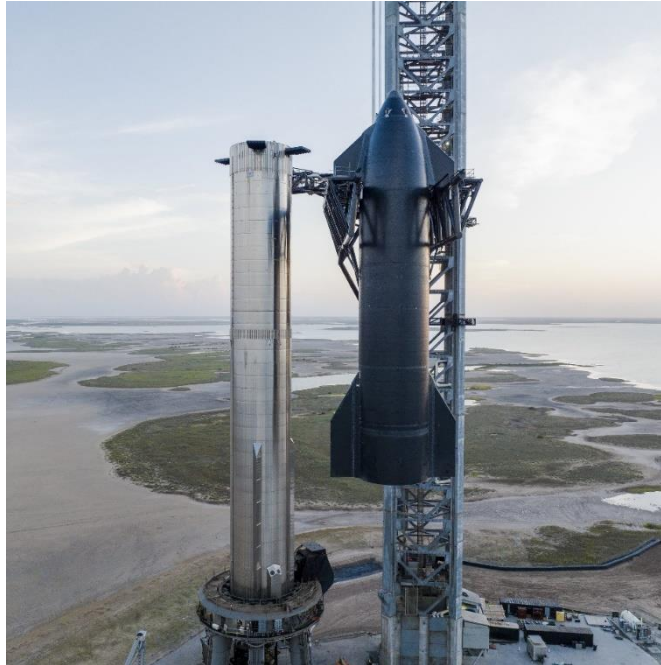
Figura 9: il potente razzo Starship di SpaceX durante l'assemblaggio sul booster Super Heavy prima del volo di prova. (Credit: SpaceX)
