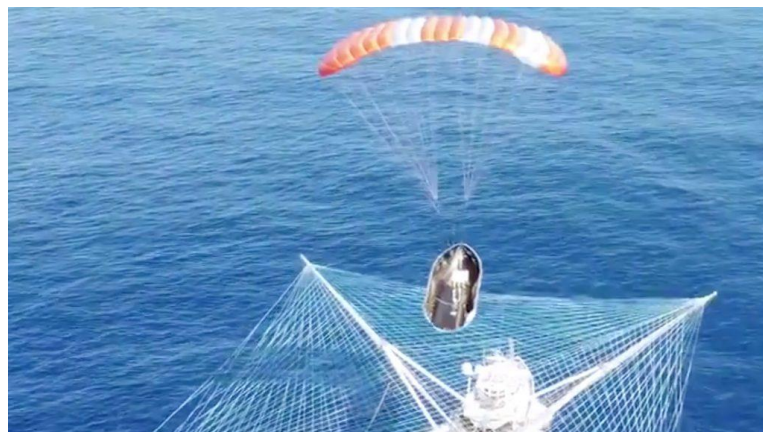
Figure 4 e 5: i fairing prima di essere montati sulla punta del razzo a protezione del satellite e nel momento del recupero dopo il lancio (Credit: Astropace)
