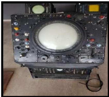
Il sistema poteva essere asservito a numerosi tipi di radar, sia di ricerca che di quota, inoltre era in grado di presentare i ritorni del Radar secondario, di fondamentale importanza ai fini dell'identificazione dei velivoli. Il settaggio in *range* poteva essere variato sia manualmente che
