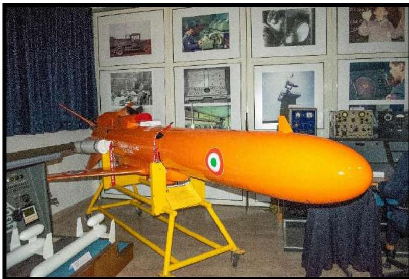
E' un drone bersaglio della seria *Mirach* a pilotaggio remoto, sviluppato e costruito dalla Galileo Avionica ed in grado di simulare l'attacco di un velivolo da combattimento o di un missile.
