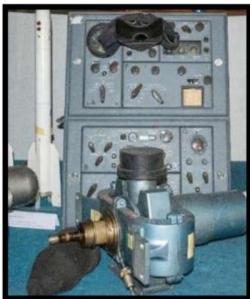
Apparato di manutenzione/ verifica/ collaudo a disposizione dei tecnici dell'area di lancio. Generalmente usato durante la fase di assemblaggio del missile o di verifica delle funzionalità della Sezione di Guida.
