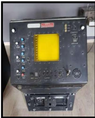
L'*Indicator Group* OA-929 costituiva la cosiddetta "console di quota" associata a quota metri di tipo AN/FPS 89 o AN/FPS 6, che si serviva di una presentazione radar di tipo R.H.I. (*Range Height Indicator*), basata su un "Tubo" a raggi catodici
